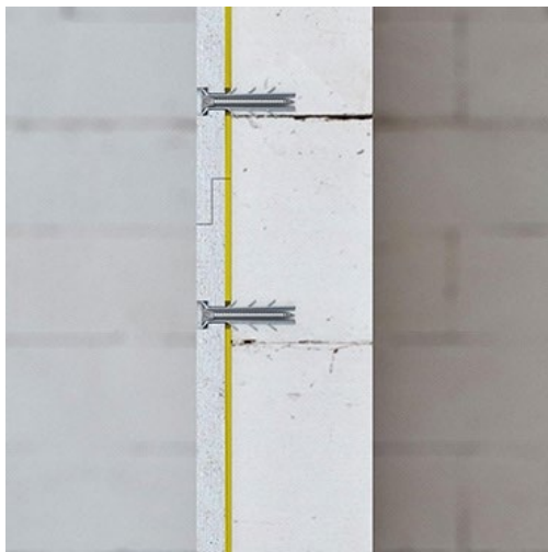
Рисунок 1. Иллюстрация звукоизоляционной бескаркасной облицовки Саундлайн-ПГП Супер (AG.P-301).
