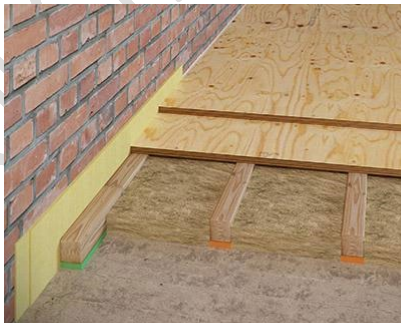
Рисунок 1. Иллюстрация конструкции звукоизоляционного пола по лагам с применением виброизолирующих опор из материала Sylomer.
