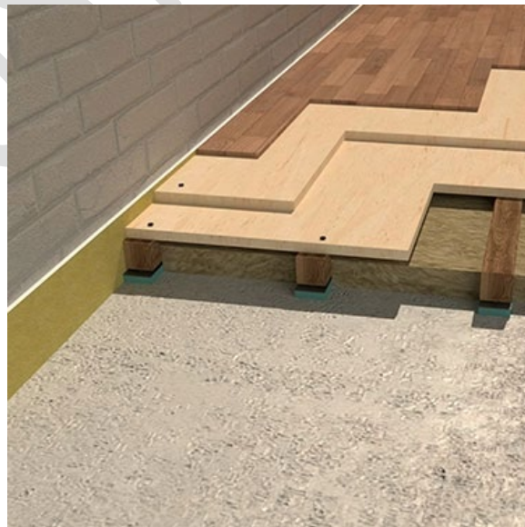
Рисунок 1. Иллюстрация конструкции звукоизоляционного пола по лагам с применением регулируемых виброизолирующих опор Виброфлекс LD.
