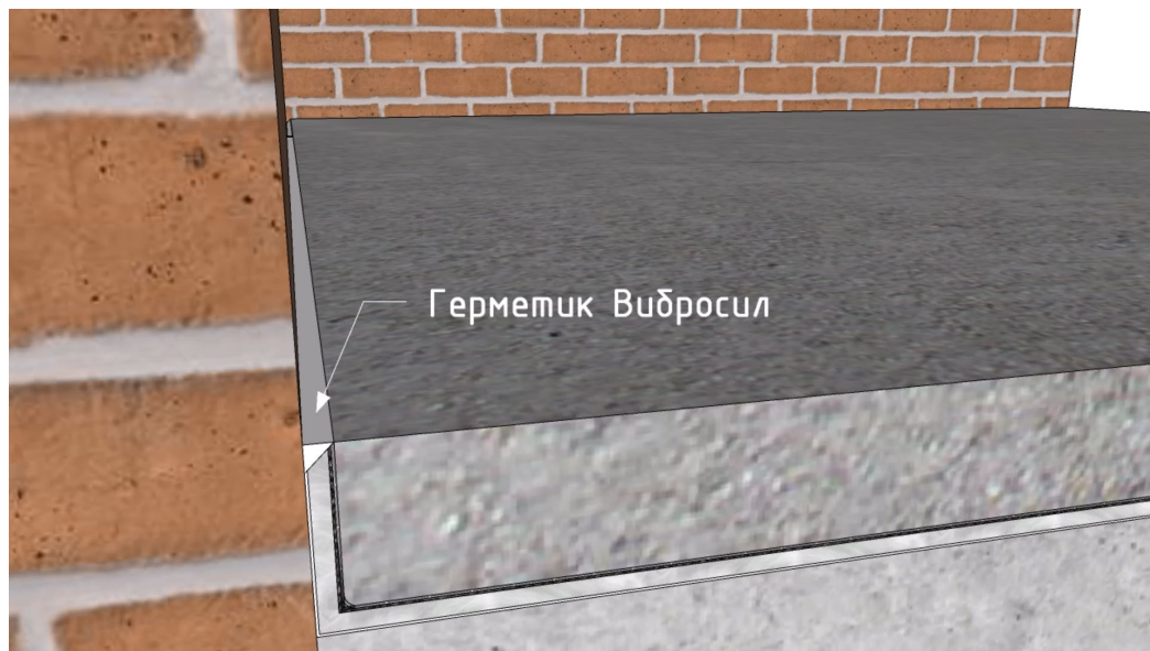
Рисунок 16. Заполнение шва герметиком Вибросил.
