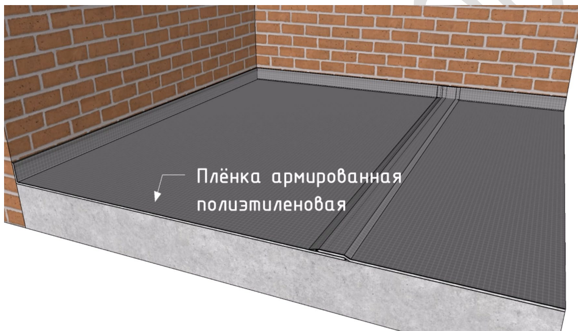
Рисунок 13. Укладка разделяющего слоя из армированной полиэтиленовой пленки.
