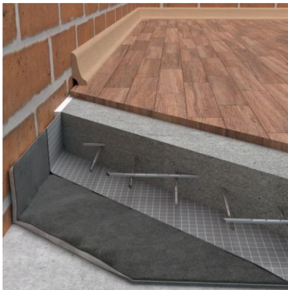
Рисунок 1. Иллюстрация конструкции звукоизолирующего пола с применением материала Шуманет-Термо.
