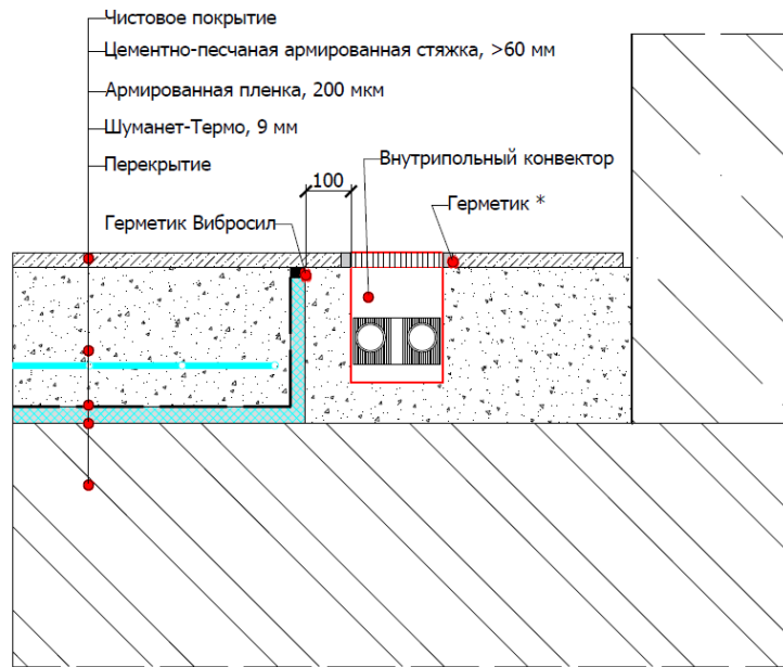
Рисунок 11. Устройство звукоизоляции пола с применением Шуманет-Термо при наличии внутрипольного конвектора. Способ №1.
