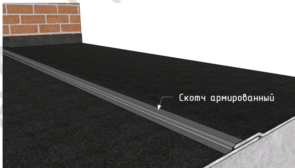
Рисунок 8. Проклейка нахлестов материала Шуманет-Термо армированным скотчем.
