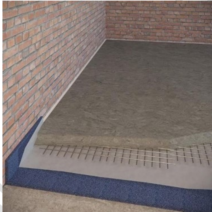
Рисунок 1. Иллюстрация конструкции звукоизолирующего пола с применением Шумопласт.
