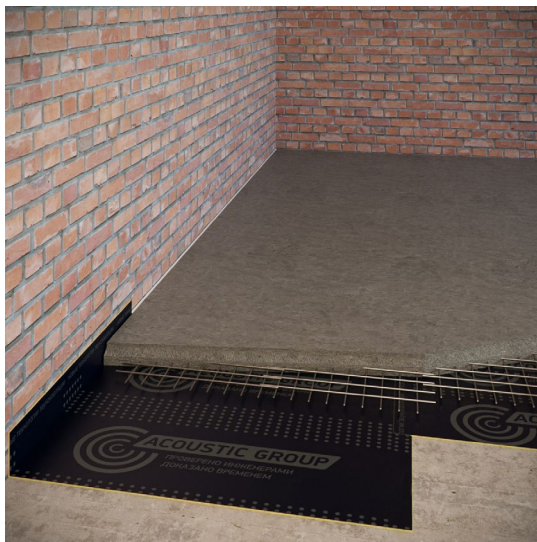
Рисунок 1. Иллюстрация конструкции звукоизолирующего пола с применением Шуманет-100Комби.
