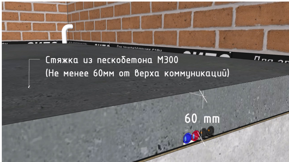
Рисунок 17. Толщина стяжки поверх материала Шуманет-100Комби/Гидро.
