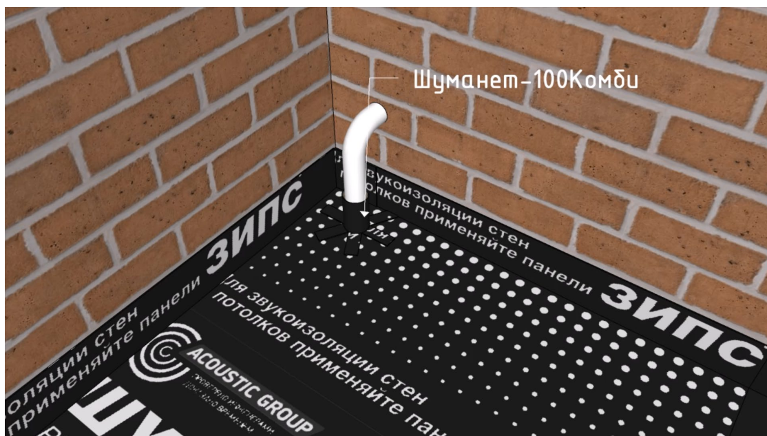
Рисунок 13. Пропуск вертикальных коммуникаций при устройстве звукоизоляции пола с применением материала Шуманет-100Комби.
