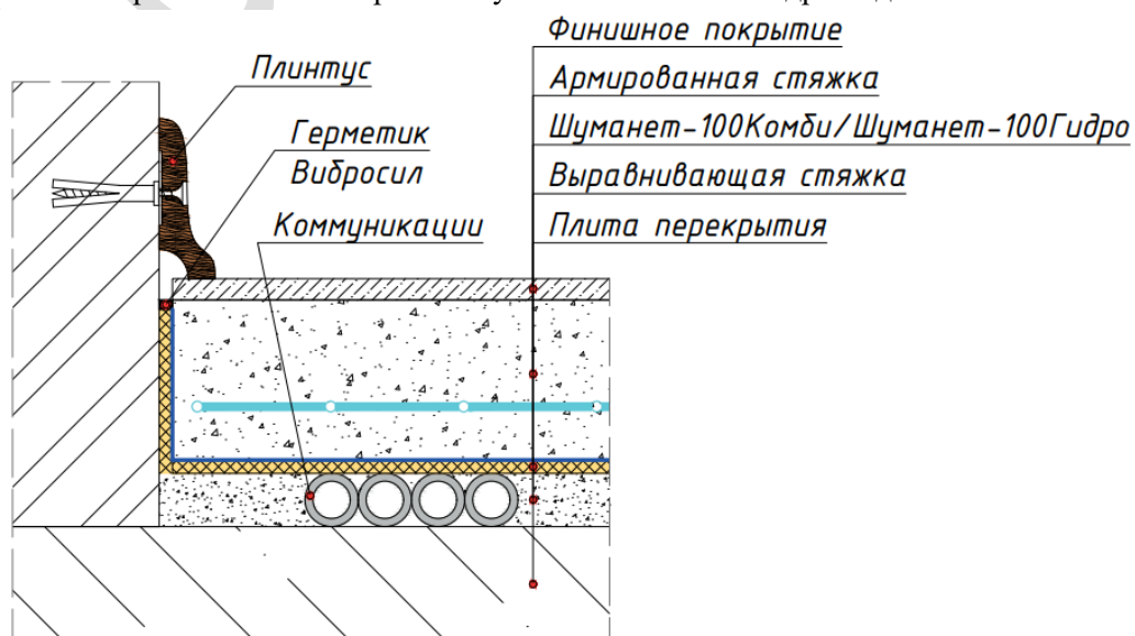
Рисунок 4. Пропуск вертикальных коммуникаций при устройстве звукоизоляции пола с применением материала Шуманет-100Комби/Гидро под стяжкой.
