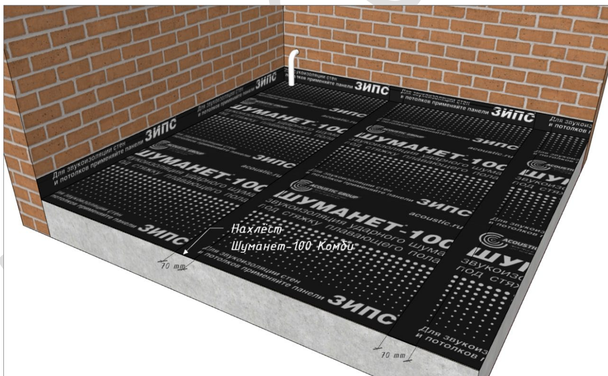
Рисунок 8. Укладка рулонов с нахлестом.
