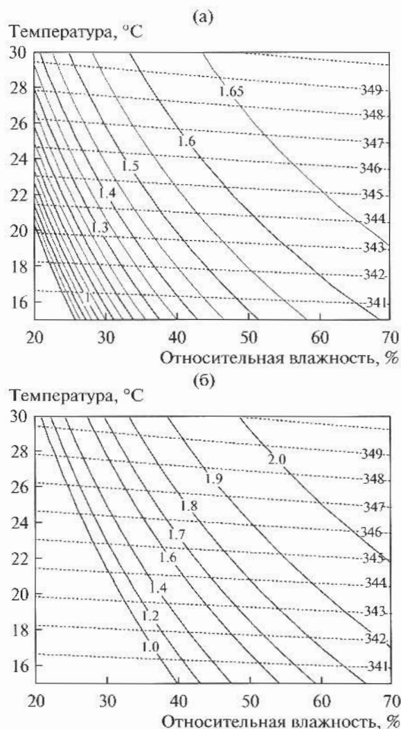
Номограммы для определения температуры и относительной влажности воздуха в помещении по измеренным значениям скорости звука (пунктирные линии) и времени реверберации (сплошные линии) на частоте 4000 Гц (а) и 8000 Гц (б) при атмосферном давлении 101325 Па.
