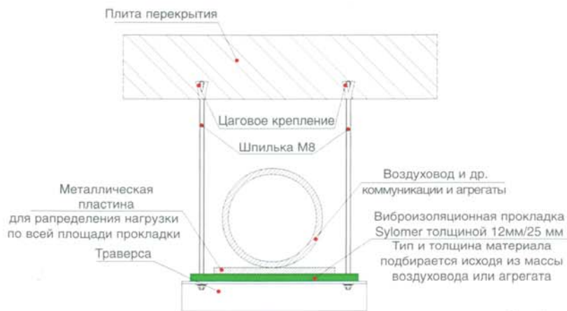
Рис. 5а, 5б. Устройство виброизоляции трубопроводов
