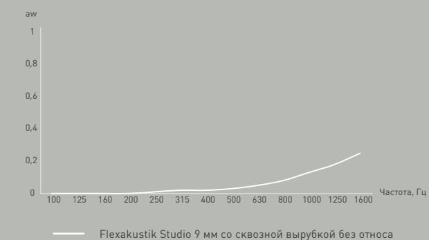
Акустическая панель Flexakustik Studio со сквозной вырубкой без отнosa
