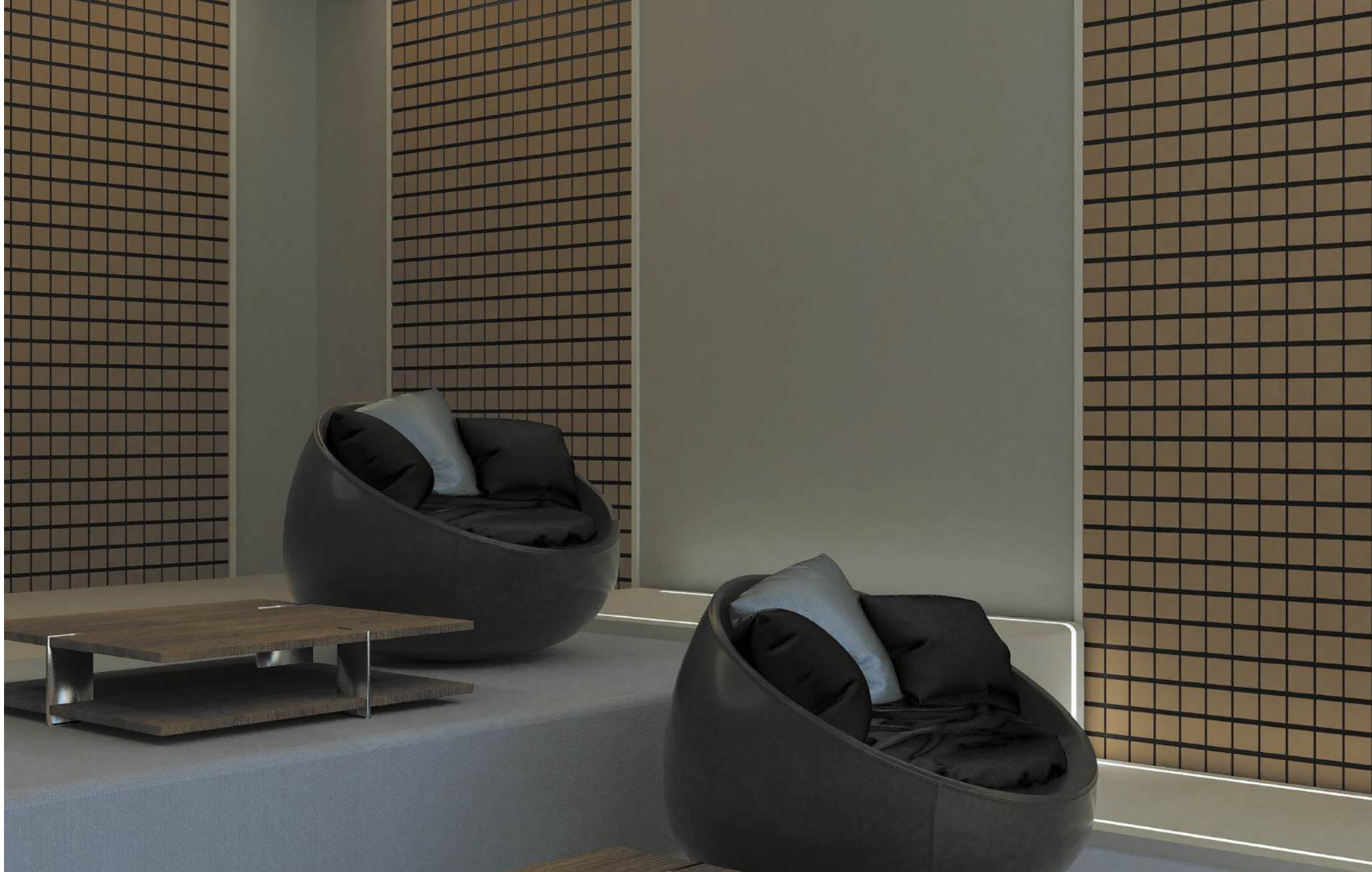
Панели с щелевой перфорацией с двумя перпендикулярными прорезями.
