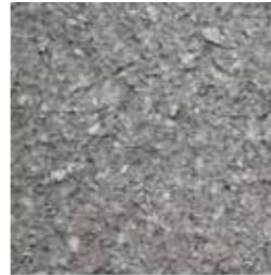
Основным компонентом являются среднедисперсные хлопья целлюлозы (4-7 мм), которые с помощью специального оборудования, смешиваясь с клеящим связующим, наносятся на обрабатываемую поверхность. Высокая адгезия позволяет напылять покрытие на любые типы поверхностей вне зависимости от их формы и состава.
