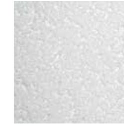
Основным компонентом являются мелкодисперсные хлопья целлюлозы (до 4 мм), которые с помощью специального оборудования, смешиваясь с клеящим связующим, наносятся на обрабатываемую поверхность. Высокая адгезия позволяет напылять покрытие на любые типы поверхностей вне зависимости от их формы и состава.
