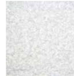
Основным компонентом являются мелкодисперсные хлопья целлюлозы (3-5 мм), которые с помощью специального оборудования, смешиваясь с клеящим связующим, наносятся на обрабатываемую поверхность. Высокая адгезия позволяет напылять покрытие на любые типы поверхностей вне зависимости от их формы и состава.
