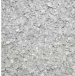
Основным компонентом являются крупнодисперсные хлопья целлюлозы (5-10 мм), которые с помощью специального оборудования, смешиваясь с клеящим связующим, наносятся на обрабатываемую поверхность. Высокая адгезия позволяет напылять покрытие на любые типы поверхностей вне зависимости от их формы и состава.
