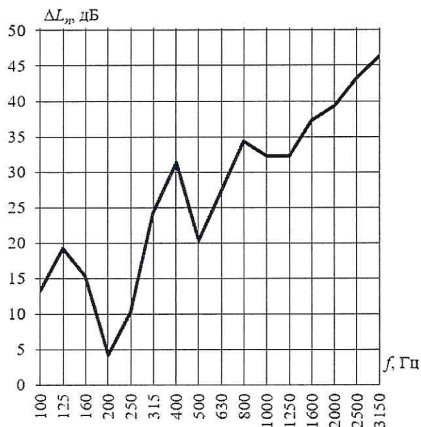
Рисунок - Частотная характеристика улучшения изоляции ударного шума под перекрытием конструкцией пола
