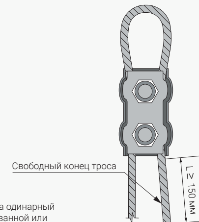
Рисунок 9. Минимально допустимая длина свободного конца троса для его обрезки
