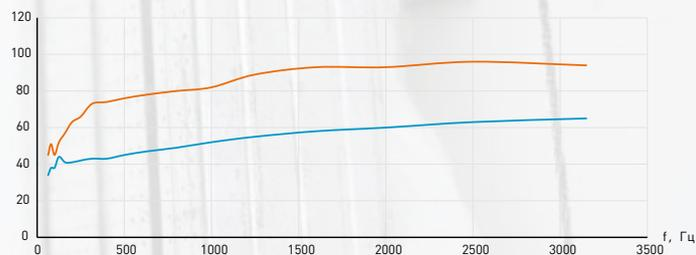
— Звукоизоляция кирпичной стены 120 мм с облицовкой, выполненной на креплениях ВИБРОФЛЕКС-КОННЕКТ ПС,  $R_w = 75$  дБ
