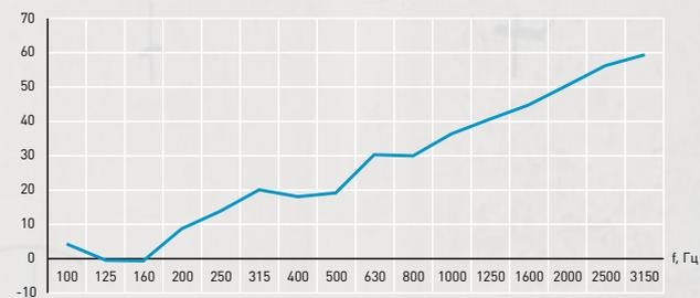
— снижения уровня ударного шума конструкцией пола при толщине 20 мм
