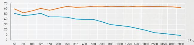
— Монолитная ж/б плита перекрытия толщиной 200 мм
