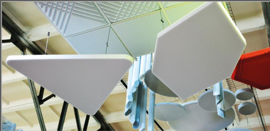
Звукопоглощающие плиты из огнестойкой пены FLEXAKUSTIK-FR – это стенные и потолочные панели, сборные и объемные композиции, а также различные геометрические фигуры с возможностью окраски в любой цвет по RAL.
