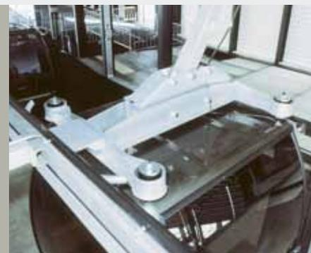
Виброизоляционная прокладка для кабин
