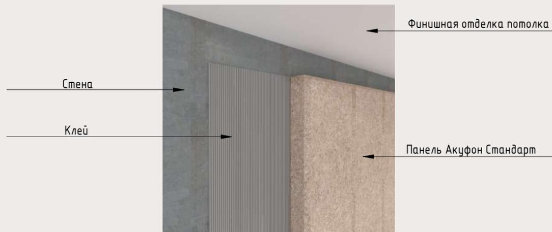
Узел примыкания панели к потолку.
