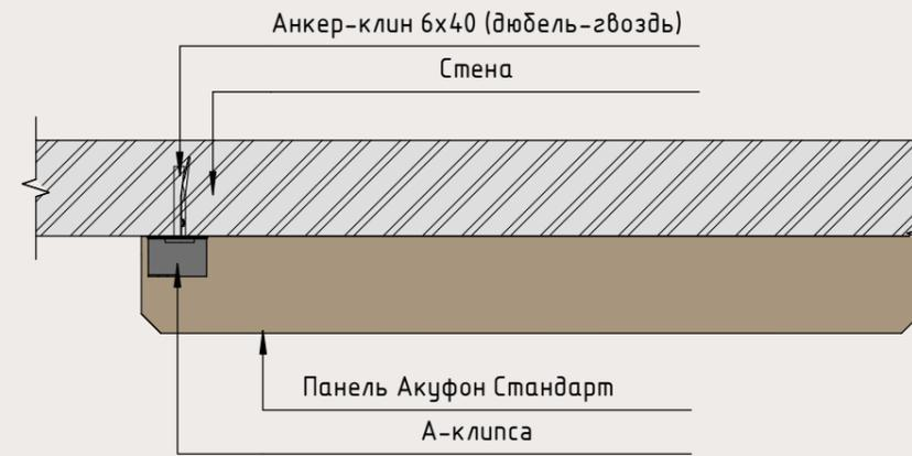
Вид примыкания панели к стене
