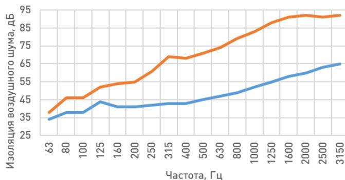
— Перегородка из силикатного кирпича толщиной 120 мм,  $R_w = 51$  дБ
