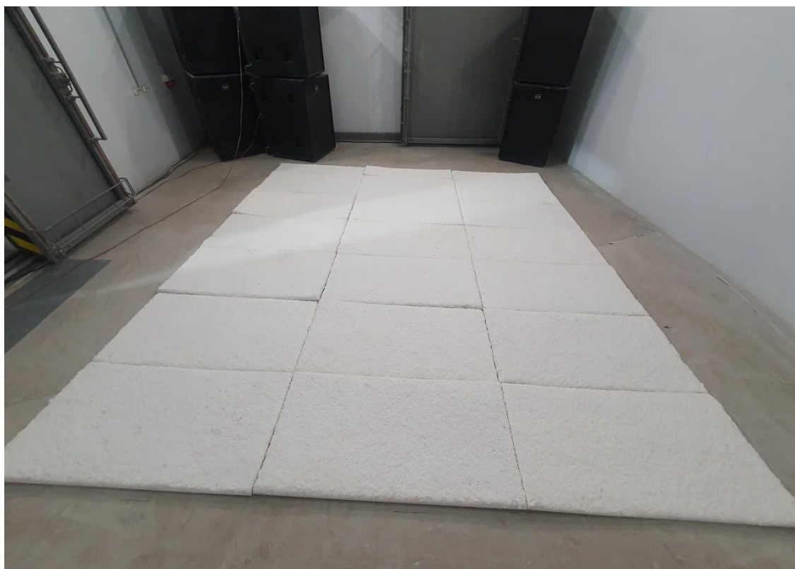
Рисунок 1.2 – Образец конструкции №2, смонтированный на полу реверберационной камеры
