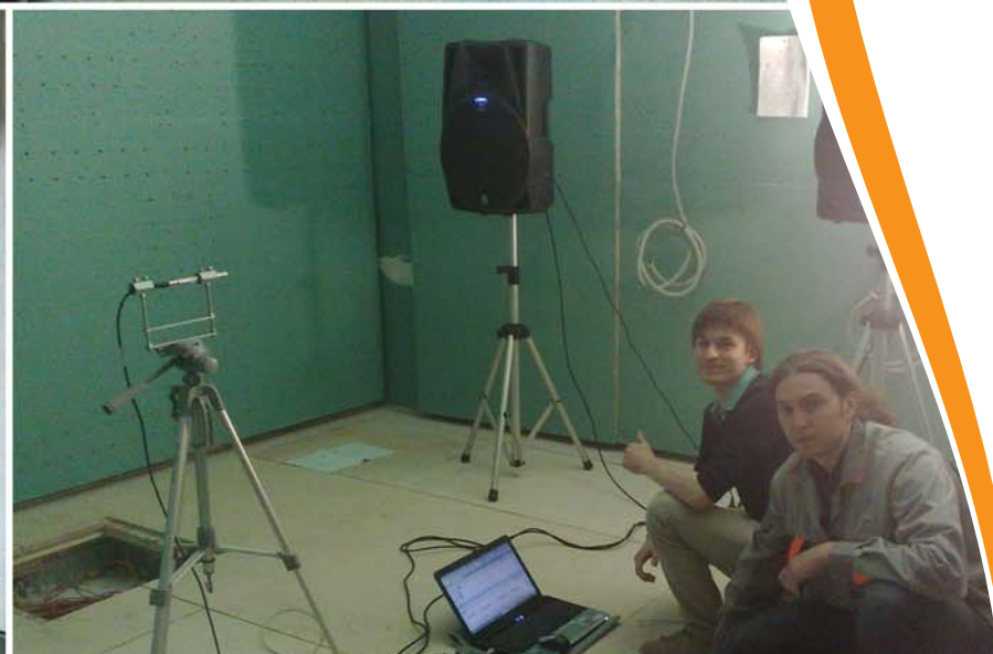
Проведение акустических измерений в студии звукозаписи Московской консерватории
