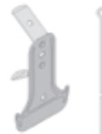
Анкерный подвес вставляется в профиль ПП 60/27 и дополнительно фиксируется защелкой, находящейся в нижней части подвеса. Тяга имеет диаметр 4,0 мм и производится длиной от 125 до 1500 мм, что позволяет подобрать необходимое внутрипотолочное пространство. Крепится тяга к подвесу через отверстия в разжимной пластине.
