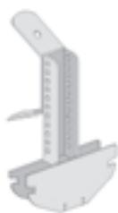
Комбинированный подвес применяется для крепления каркаса подвесного потолка из профилей ПП 60/27 к несущему основанию. Крепление комбинированного подвеса к несущему основанию выполняется при помощи верхней части нониус-подвеса с 2-мя фиксаторами.
