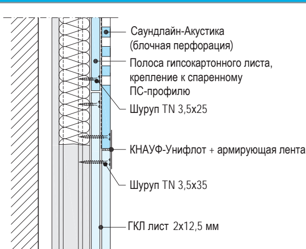
Каркас из спаренного ПС-профиля. Формирование стыка при блочной перфорации
