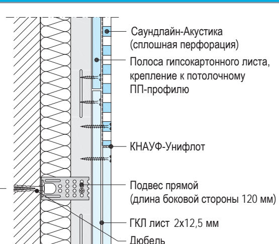
Каркас из потолочного ПП-профиля. Формирование стыка при сплошной перфорации
