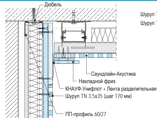
Каркас из спаренного ПС-профиля. Присоединение к потолку.
